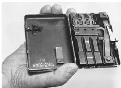
Рисунок 1 — Трехзарядное стреляющее устройство ТКБ-506А, производства СССР, калибра 7,62 мм, в виде портсигара
