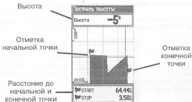
Рисунок 15 — Значение профиля высоты и расстояния до начальной и конечной точки
